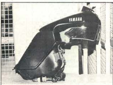
Le réservoir est loin d'être commun. Le remplissage se fait normalement, mais le réel compartiment d'essence est au rez-de-chaussée. La partie supérieure est creuse en partie, mais accueille les éléments complémentaires du tableau de bord.
